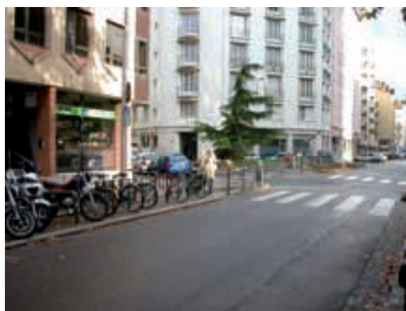
La visibilité entre les piétons et les véhicules est dégagée grâce à l'avancée de trottoir et à l'espace réservé au stationnement des vélos (photo : Certu)
