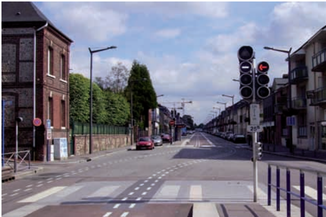
Ce tronçon de la ligne TEOR est composé d'un site central aménagé selon le principe de « couloir d'approche » de quelques dizaines de mètres en amont des carrefours (photo : Cete Normandie -Centre).
