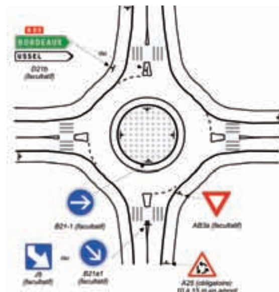
Schéma de principe d'implantation de la signalisation verticale ; seul le panneau A25 est obligatoire.
